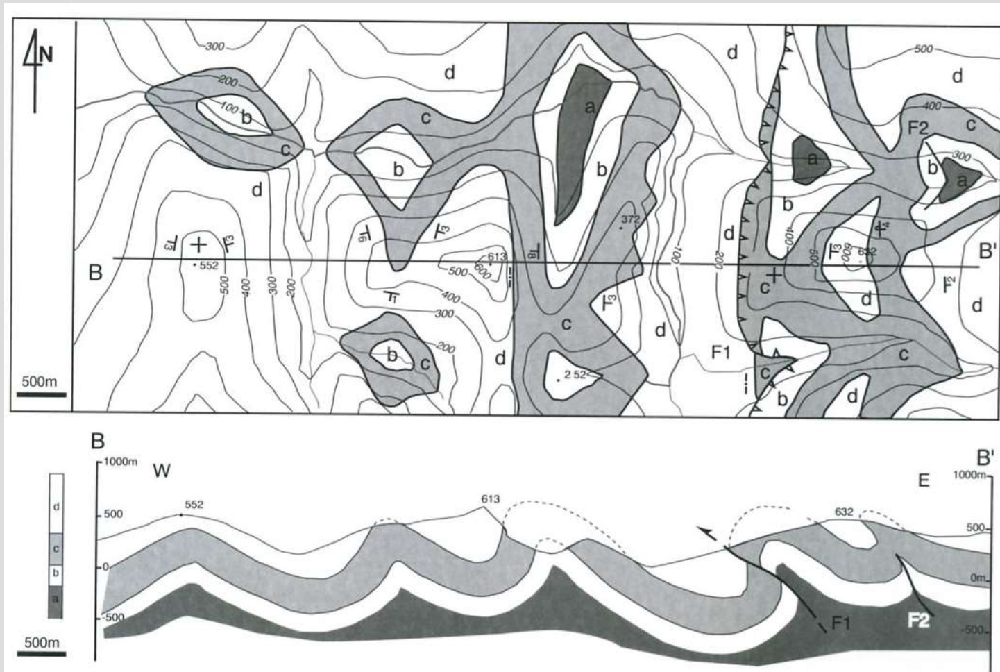
Structure plissée : carte et coupe schématique
