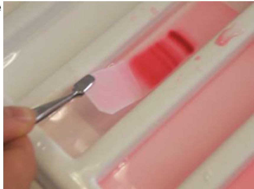
Révélation: bains successifs dans l'acide acétique après la coloration au rouge Ponceau
