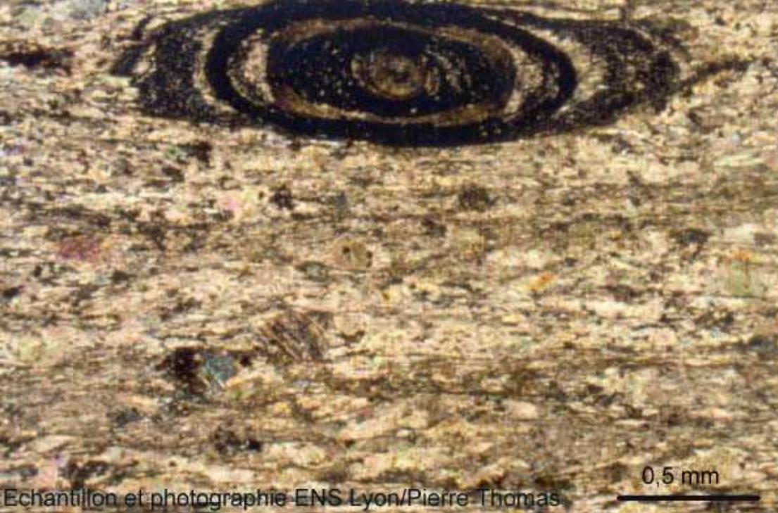
**Document 17 (à gauche).** Lame mince dans un calcaire oolitique étiré (calcaire jurassique des Corbières méridionales) observée en lumière polarisée analysée (LPA) au faible grossissement. **Document 18 (à droite).** Lame mince de calcaire oolithique non déformé.
