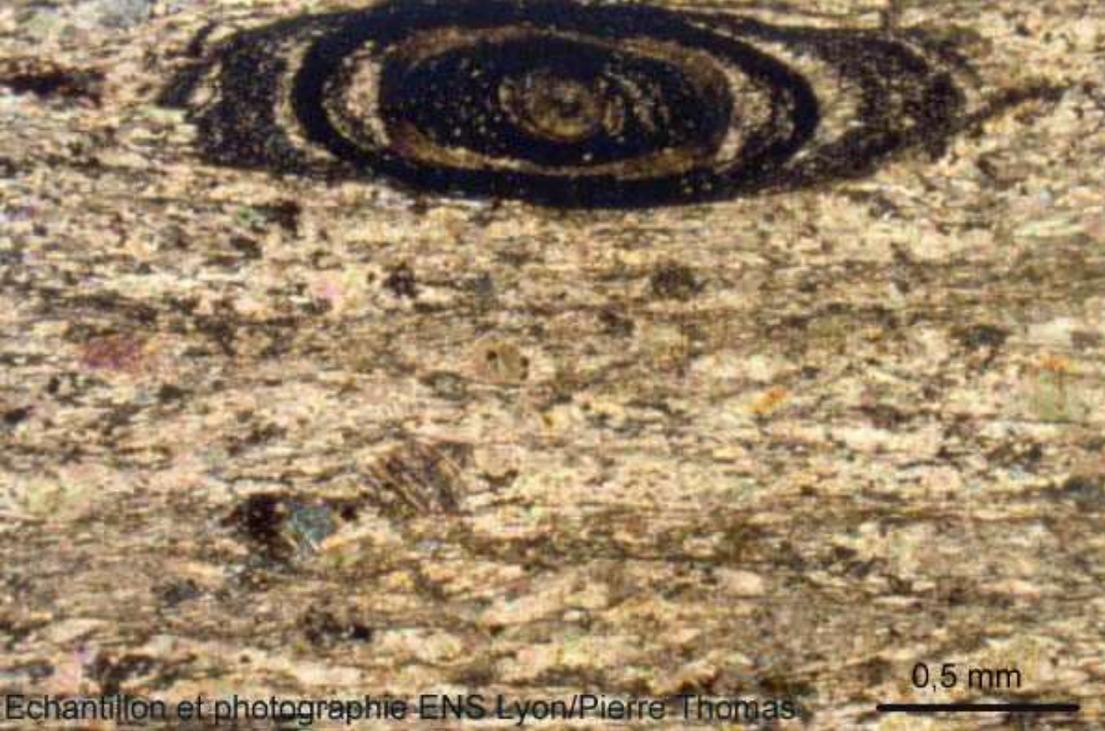
**Document 17 (à gauche).** Lamelle mince dans un calcaire oolithique étiré (calcaire jurassique des Corbières méridionales) observée en lumière polarisée analysée (LPA) au faible grossissement. **Document 18 (à droite).** Lamelle mince de calcaire oolithique non déformé.
