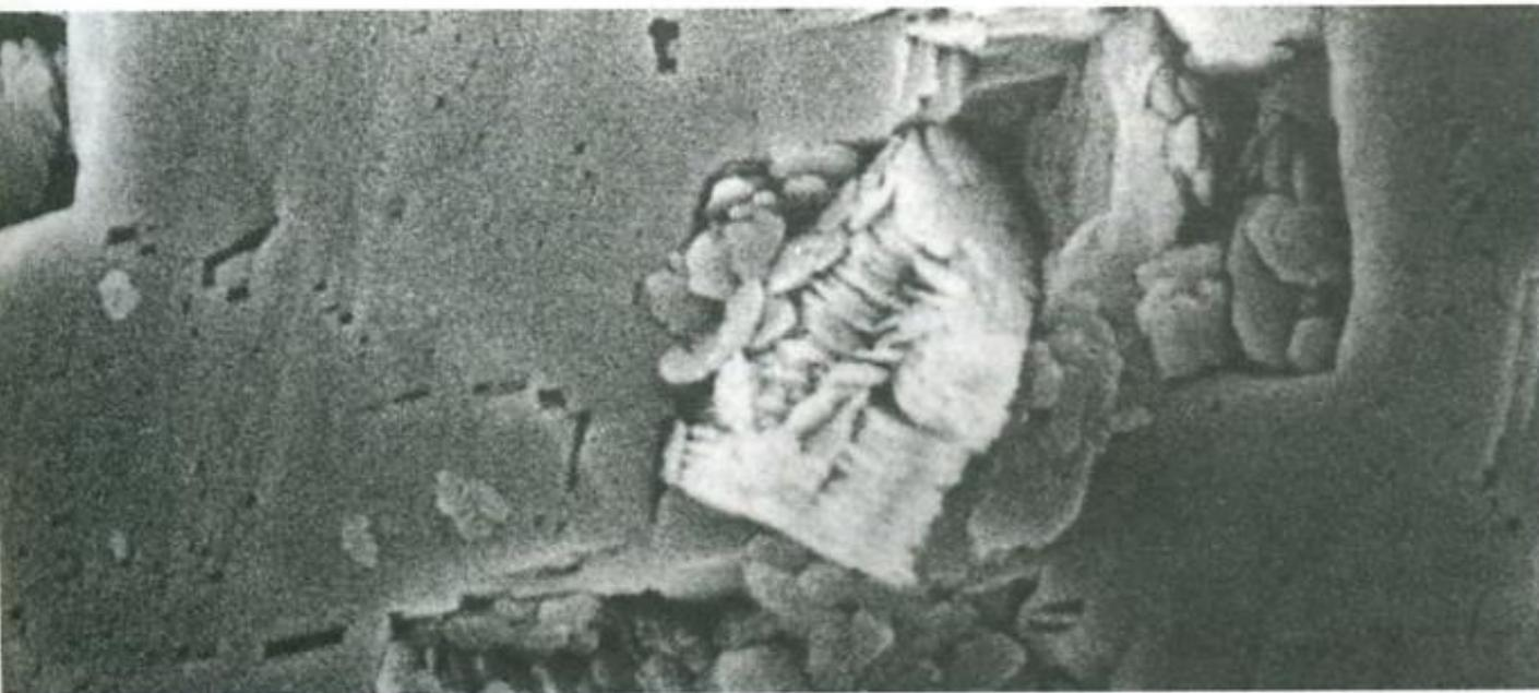
◀ 3. Cristal d'orthose avec développement de minéraux argileux d'altération.
