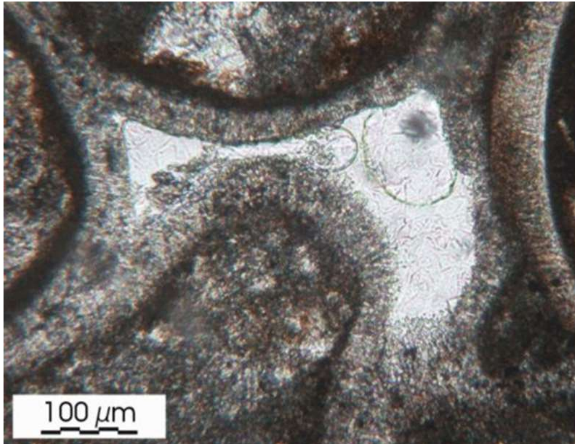
Document 7. Cristallisation de calcite fibreuse (type sparite) dans une cavité d'un calcaire aujourd'hui à l'affleurement.
