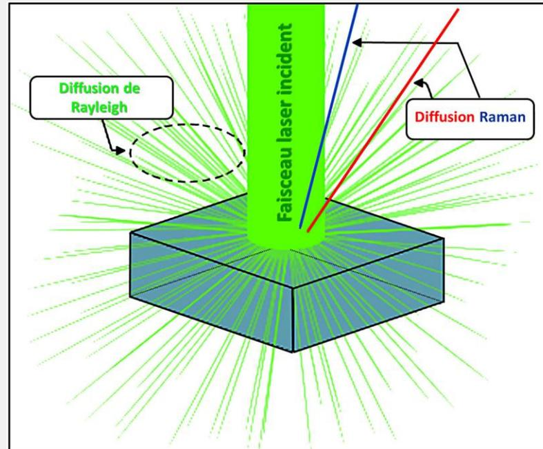
La spectroscopie Raman repose sur la mise en évidence des vibrations moléculaires par le changement de longueur d'onde de la lumière qui se diffuse dans la matière.
