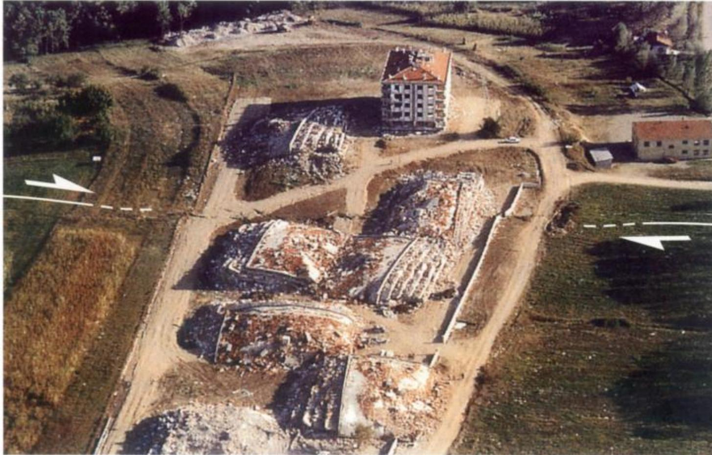
On voit très nettement la rupture (traits et pointillés blancs) qui a cisailé les immeubles. Son rejet (de l'ordre de 2 m ici) apparaît clairement par le décrochement du mur d'enceinte et son sens de déplacement (dextre) est compatible avec celui de la faille nord-anatolienne.
